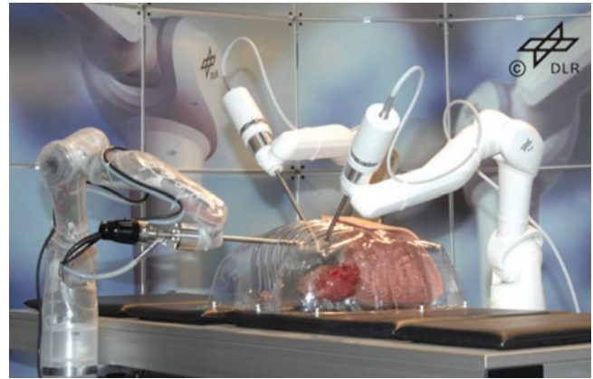
Fig. 1.11 The MIRO surgical system (courtesy of Deutschen Zentrums für Luft- und Raumfahrt [DLR])
